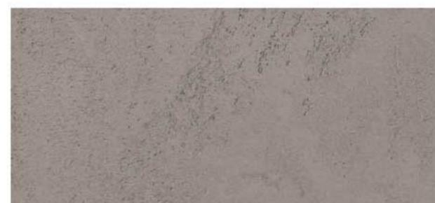
**EFFECTO CEMENTO:** en la mano final del producto y todavía fresca, realizar veteados casuales e irregulares para simular la textura del hormigón cara vista utilizando el tampón veteador. Cuando el producto comience a secarse, se deberá aplastar y compactar con una llana de acero hasta obtener el grado de alisado deseado. Dependiendo del modo en que se realice el trabajo de acabado, se podrán obtener diferentes efectos cromáticos clarososcuros.
